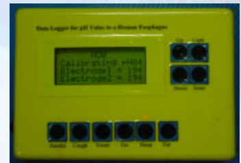
รูปที่ 1 เครื่องต้นแบบเครื่องวัดและบันทึกค่าพีเอช
