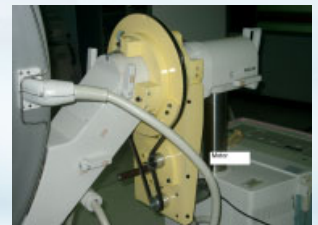
รูปที่ 5 ระบบเก็บภาพจากเครื่องเอ็กซเรย์ C-ARM แบบอัตโนมัติ
